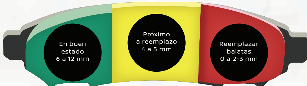
Balatas: Gráfica comparativa de desgaste
