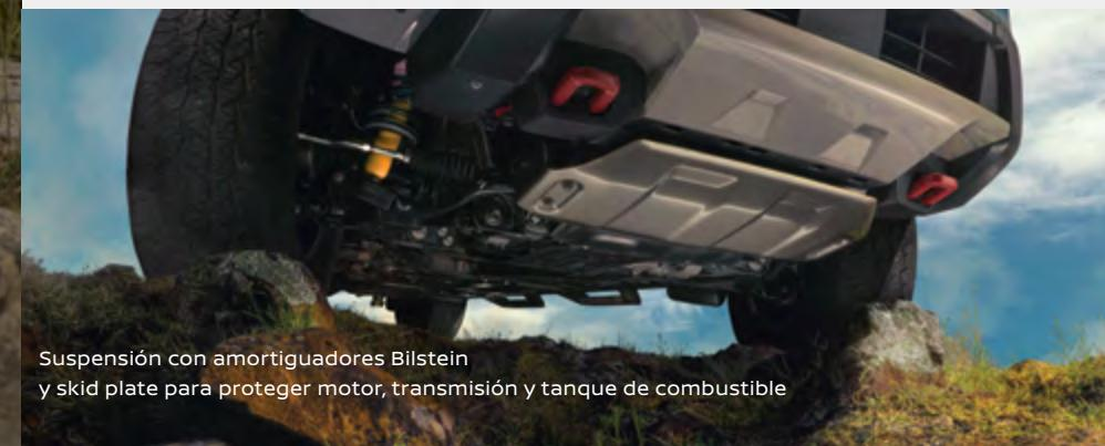
Suspensión con amortiguadores Bilstein y skid plate para proteger motor, transmisión y tanque de combustible
